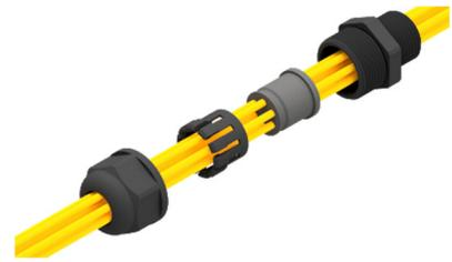
Втулка мультикабельная MG20-6x3,6 предназначена для установки в кабельный ввод MG20 корпуса оптического оборудования и герметичного подключения оптических шнуров от оборудования к оптическим адаптерам в точке назначения.
