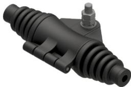
Зажим поддерживающий AQM-100-XX предназначен для подвески ОК на опоры ВЛ напряжением до 10 кВ, контактной сети и автоблокировки ЖД, освещения, связи, городского электрического транспорта, с углами поворота трассы до 15° и длиной пролета до 100 м включительно.
