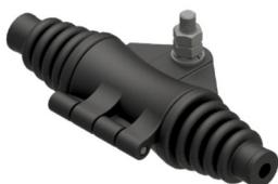
Зажим поддерживающий ADSS 3ПМ-14 предназначен для подвески оптического кабеля на опоры ВЛ напряжением до 10 кВ, контактной сети и автоблокировки ЖД, освещения, связи, городского электрического транспорта, с углами поворота трассы до 15° и длиной пролета до 100 м включительно.
