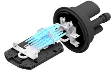
Предназначена для защиты мест сварки оптического кабеля. Конструкция муфты-кросс МВОТ-К-64 позволяет сращивать несколько кабелей вместе, а расширенное внутреннее пространство позволяет уложить транзитные модули с соблюдением всех допусков.
