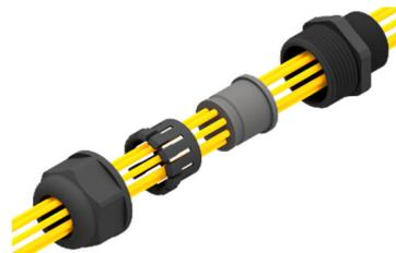
Втулка мультикабельная MG25-8x3,6 предназначена для установки в кабельный ввод MG25 корпуса оптического оборудования и герметичного подключения оптических шнуров от оборудования к оптическим адаптерам в точке назначения.
